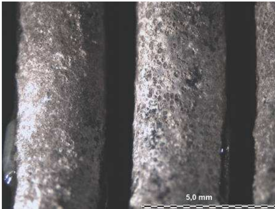
Figuur 4 detailopname van vervuiling
