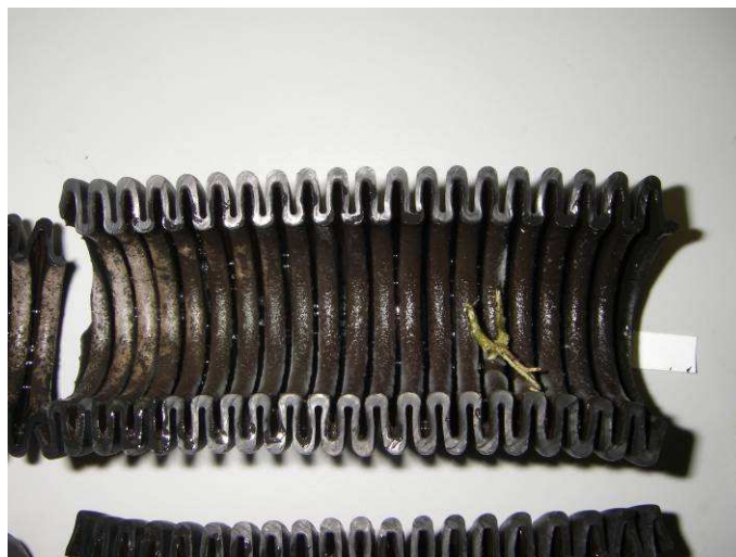
Figuur 3 detail opengewerkte adembuis met daarin o.a vervuiling met gras
