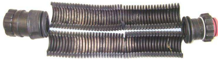
Figuur 2 opengewerkte ademslang van een LARVII
